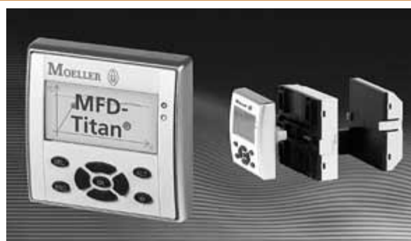
MFD-Titan – это, по сути, сразу три прибора: дисплей и клавиатура, высокоскоростной процессор с 10 стандартными языками, блок аналоговых и цифровых входов/выходов. Новые модули MFD-CP4-500/MFD-CP4-800 с напряжением питания 115/240В предназначены для подключения и питания удаленного дисплея со степенью защиты IP65. Оба типа модулей предназначены для Easy серий 500/700 и 800. Эти модули комплектуются пятиметровым кабелем, удаленность модулей до 1000 м. Драйверы для связи уже не нужны, поскольку MFD-CP4 располагает возможностью удаленного подключения дисплея, который имеет подсветку фона и высокое разрешение
