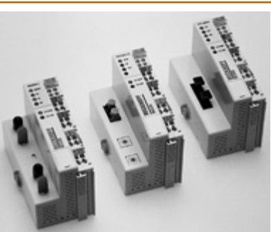
1996 г. – Серийный выпуск модулей, контроллеров "стандартного" и "экономичного" класса (BKxx00, BKxx10) для шин PROFIBUS, Lightbus, Interbus, CANopen и DeviceNet
