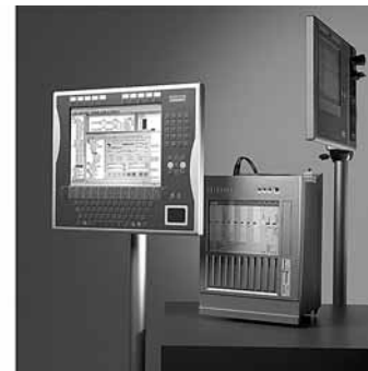
1998 Распределительный шкаф – ПК со ступенчатой панелью управления
