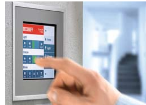
Ethernet-панель управления CP6608 со встроенным компьютером хорошо приспособлена для решения широкого диапазона задач промышленной автоматизации. Она может использоваться как простая сенсорная панель управления или как контроллер на базе ПК
